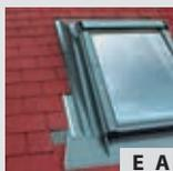
**ESA, EHA** - Dieser Eindeckrahmen ermöglicht den Einbau von FAKRO Dachflächenfenstern schon ab einer Dachneigung von 10 Grad, da der Neigungswinkel zwischen dem Fenster und der Dachfläche um 10 Grad erhöht wird. Somit gewinnt man mit Hilfe eines Aufkeilrahmens bei flachen Dächern mehr Kopffreiheit und eine bessere Aussicht.
