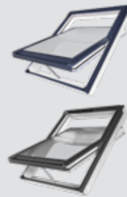
FTU-V P50 Z-Wave, FTU-V P50 Solar · Schwingfenster aus Holz mit weisser Polyurethanschicht · Zulässige Dachneigung 15° bis 90° · Uw = 1,0 W/m 2 K · Rw = 39 dB (FTU-V P50 Z-Wave/Solar) · Rw = 40 dB (FTU-X P50 Z-Wave/Solar) · g = 46% (Energiedurchlassgrad)
