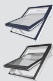
FTU-V P20 Z-Wave, FTU-X P20 Z-Wave, FTU-V P20 Solar, FTU-X P20 Solar · Schwingfenster aus Holz mit weisser Polyurethanschicht · Zulässige Dachneigung 15° bis 90° · Uw = 1,3 W/m 2 K · Rw = 37 dB (FTU-V P20 Z-Wave/Solar) · Rw = 39 dB (FTU-X P20 Z-Wave/Solar) · g = 52% (Energiedurchlassgrad)
