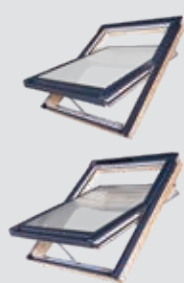
FTP-V P50 Z-Wave, FTP-V P50 Solar · Schwingfenster aus Holz · Zulässige Dachneigung 15° bis 90° · Uw = 1,0 W/m 2 K · Rw = 39 dB (FTP-V P50 Z-Wave/Solar) · Rw = 40 dB (FTP-X P50 Z-Wave/Solar) · g = 46% (Energiedurchlassgrad)
